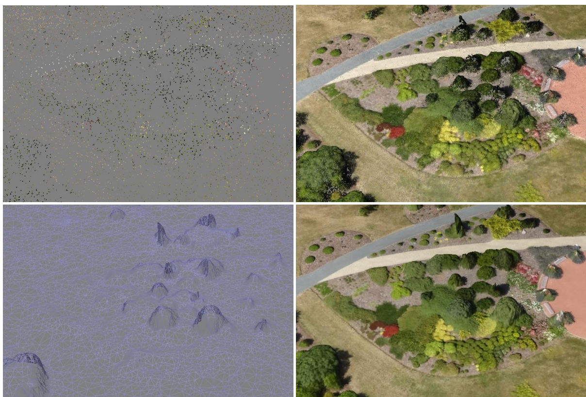
Obrázek 50. Kroky zpracování dat UAS na příkladu Libosadu v kampusu ČZU. Řídké mračno bodů SfM (vlevo nahoře), zahuštěné bodové mračno (obarvené) MVS (vpravo nahoře), triangulace bodů, resp. polygonová síť (vlevo dole) a na modelu vytvořená textura (vpravo dole).
