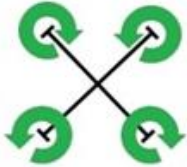
Obrázek 6. Protisměrný chod sousedních rotorů zabraňuje svévolné rotaci stroje na místě.
