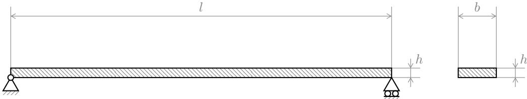
Úkolem je najít průhyb prostě uloženého ocelového nosníku s konstantním obdélníkovým průřezem, který je zatížený vlastní vahou. Parametry nosníku jsou:
