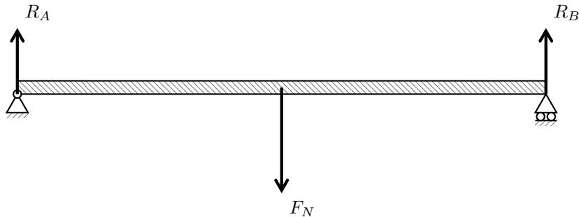
Abychom zjistili hodnotu  $M$  v bodě  $x \in \langle 0, l \rangle$ , oddělíme část nosníku odpovídající intervalu  $\langle 0, x \rangle$ .
