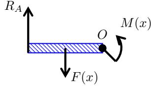
Na oddělenou část nosníku působí reakce  $R_A$  a tíha  $F(x)$  oddělené části, kde  $F(x) = \varrho h b x g$ . Vzhledem k bodu  $O$  tak vzniknou momenty síly o velikostech  $R_A \cdot x$  a  $F(x) \cdot \frac{x}{2}$ . Protože je oddělená část nosníku ve statické rovnováze, musí být součet momentů nulový. Vzhledem k bodu  $O$  tedy existuje ještě moment síly  $M(x)$  a platí:
