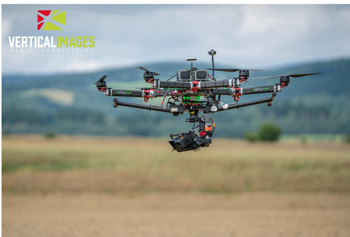
Obr. 1 Bepilotní letadlo (multicopter) s termokamerou WIRIS používanou Vertical Images k lokalizaci zvěře.
