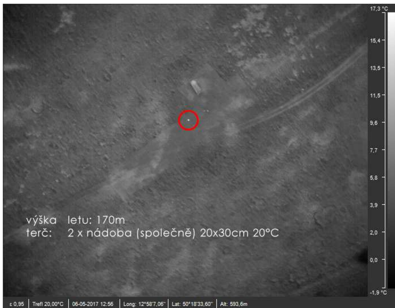
Obr. 7 Test s termokamerou WIRIS 640x512 a objektivem 13 mm - let ve výšce 170 metrů nad zemí. V kroužku vidíte dvě nádoby naplněné teplou vodou.
