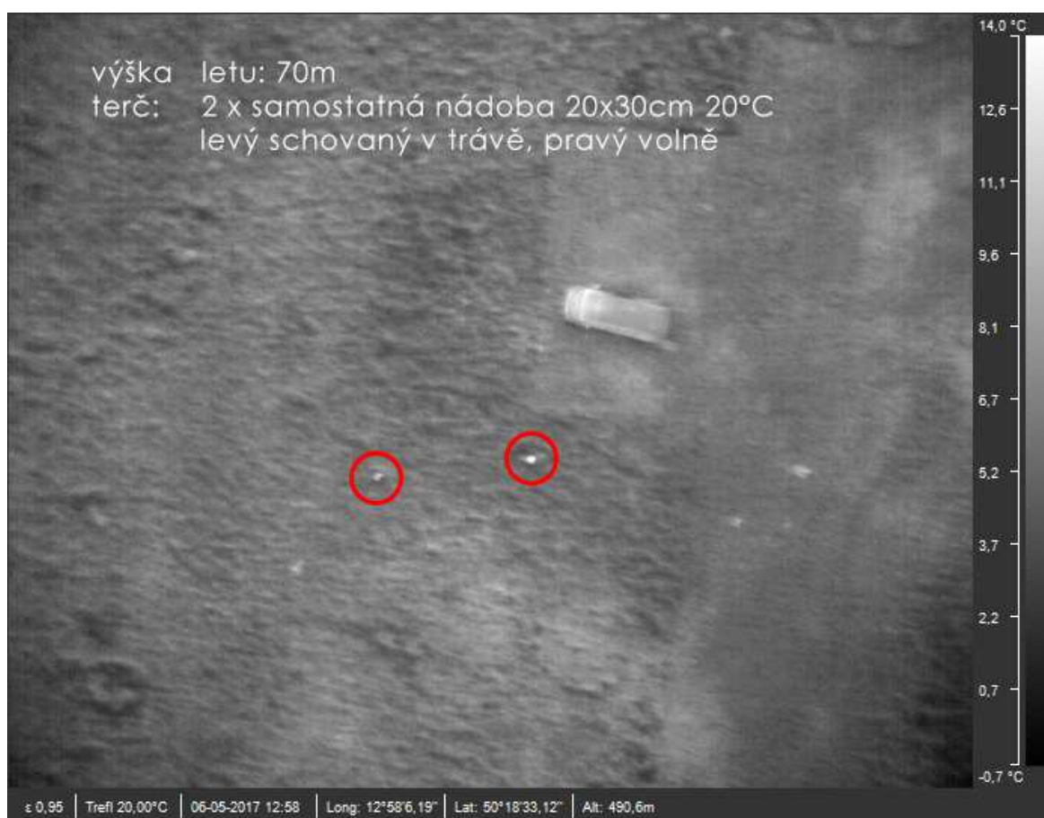
Obr. 4 Test s termokamerou WIRIS 640x512 a objektivem 13 mm - let ve výšce 70 metrů nad zemí. Kroužkem jsou označeny nádoby naplněné teplou vodou. Levá je přikrytá v trávě, pravá leží volně.
