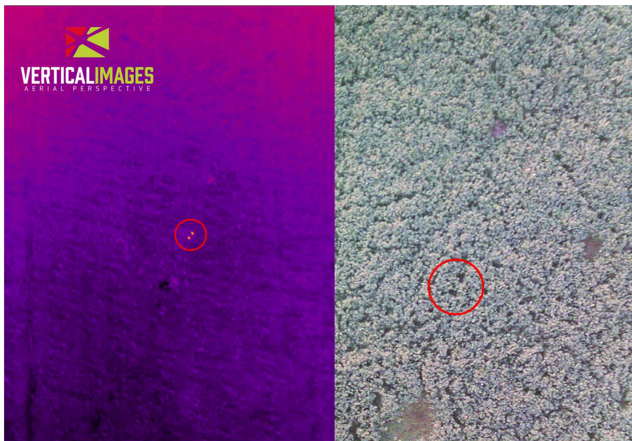
Obr. 10 Ukázka výsledků z reálného nasazení. Použitá termokamera WIRIS 640x512 s objektivem 13 mm. Let ve výšce 25 metrů nad zemí. V kroužku vidíte 2 srnčata.
