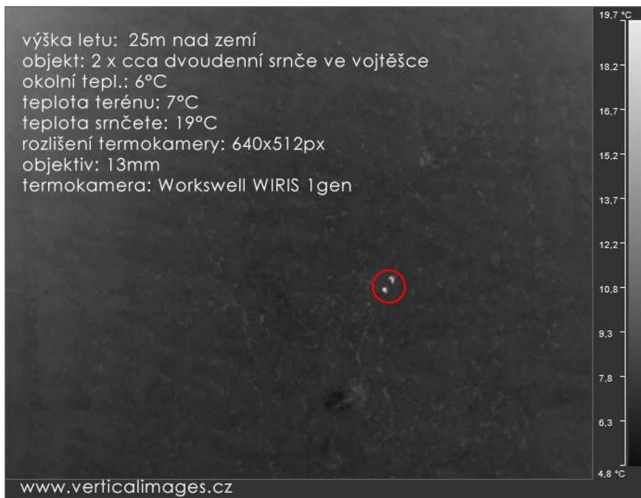
Obr. 9 Ukázka výsledků z reálného nasazení. Použitá termokamera WIRIS 640x512 s objektivem 13 mm. Let ve výšce 25 metrů nad zemí. V kroužku vidíte 2 srnčata.
