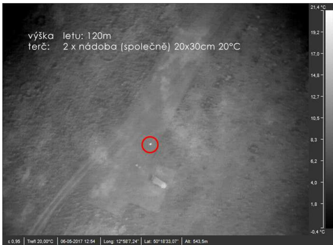
Obr. 6 Test s termokamerou WIRIS 640x512 a objektivem 13 mm - let ve výšce 120 metrů nad zemí. V kroužku vidíte dvě nádoby naplněné teplou vodou.
