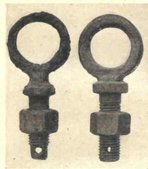
Abb. 308. Angriff von Grundwasser auf die schmiedeeiserne Öse eines Rohrbrennens aus Gußeisen.
