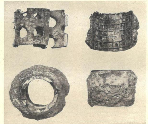
Abb. 311. Verstopfung eines Filterkorbes durch Bildung eines betonartigen Mantels, bestehend aus Eisen, Kalk und Sand. (Nach 2 Jahren.)
