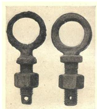
Abb. 308. Angriff von Grundwasser auf die schmiedeeiserne Öse eines Rohrbrunnens aus Gußeisen.
