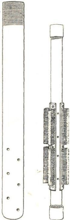
Abb. 318. Spritzrohr zum Brunnenreinigen.
