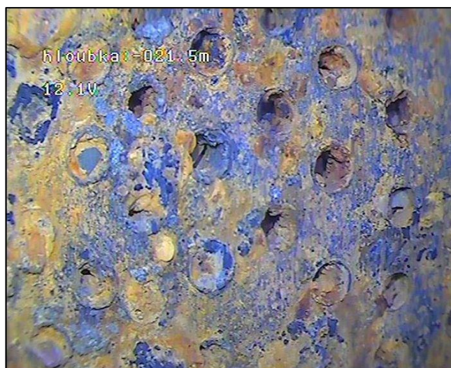
23,1 m (od O.B.) uzavřená perforace minerálními nárůsty (PŘED) 22,9 m (od O.B.) otevřená perforace (PO)
