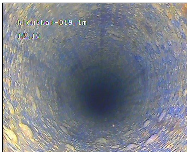
21,5 m (od O.B.) částečně otevřená perforace (PO)
