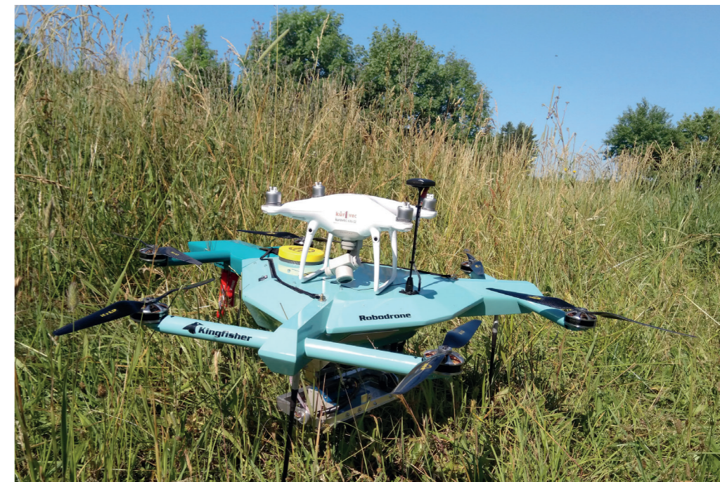
Obrázek 2 Bezpilovní systémy v terénu (vzletová hmotnost 9 a 1,5 kg). Foto Jan Komárek
