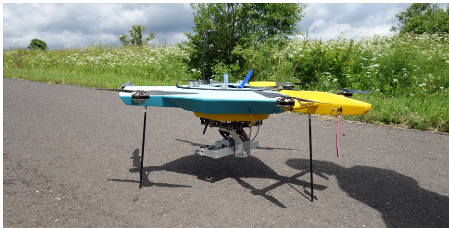
Ilustrace bezpilotního systému vybaveného multispektrální kamerou. Foto Michal Hnátek
